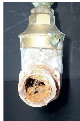
Un exemple d'oxydation dans les tuyaux d'acier
