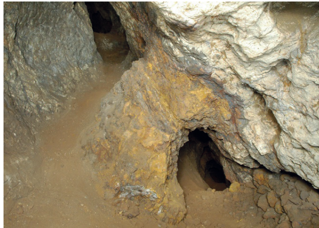
Fig. 1. — Mine de la Rambla del Abenque . Galeries antiques dans le dépilage principal
